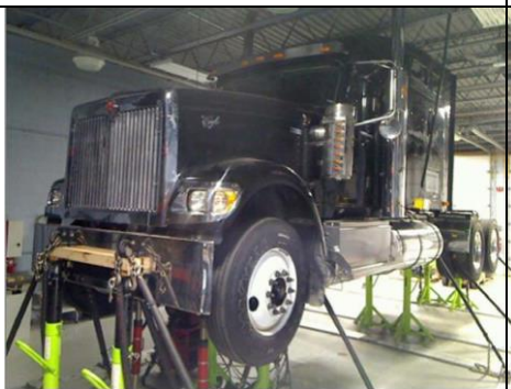
对试验台上的软管布设配置进行评估
