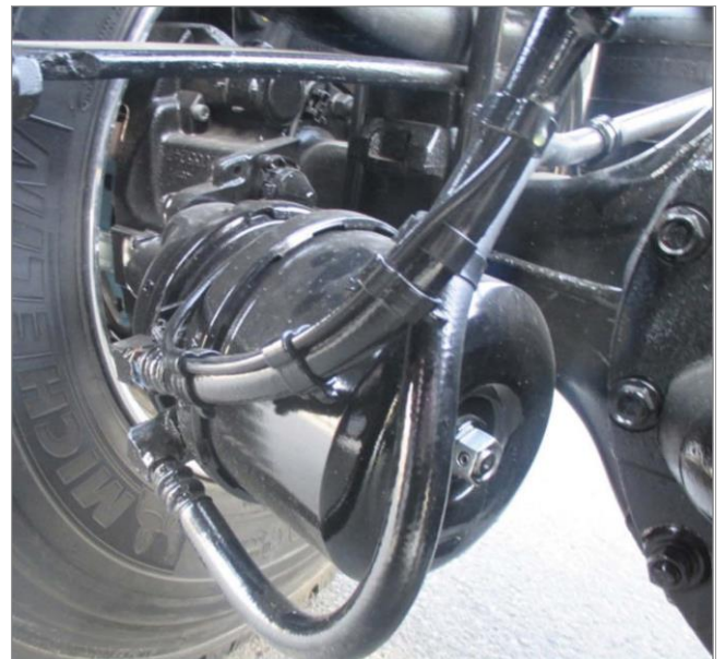
典型前后串联悬架中布设了 11 条软管
