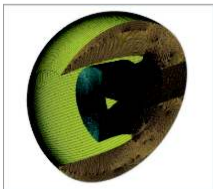
图2：风扇进气区域Actran声学网格
