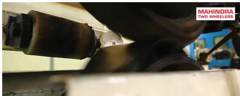
試作段階の 2 輪車を用いたドラム耐久試験
