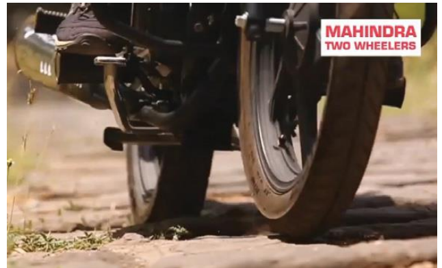
試作段階の 2 輪車を用いた悪路走行試験
