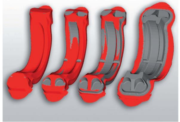
修改了预模锻模膛形状后, 仿真出没有折叠的终模锻加工变形结果。
