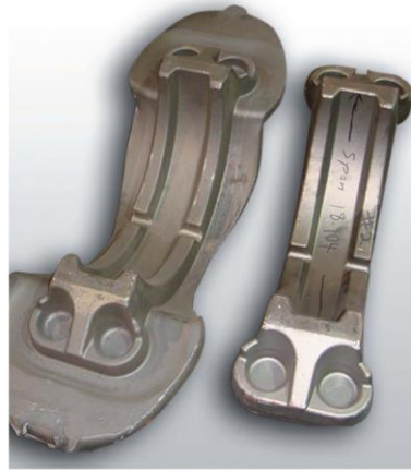
带飞边的预模锻件及 去除飞边的零件成品
