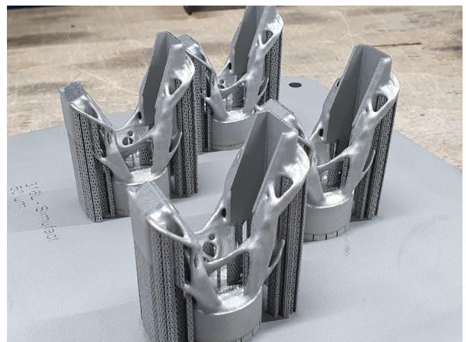
Die vier gedruckten Testobjekte aus 316L in 50 µm Schichtstärke auf der Bauplattform und noch mit Supportstruktur. Quelle: SLM Solutions.
