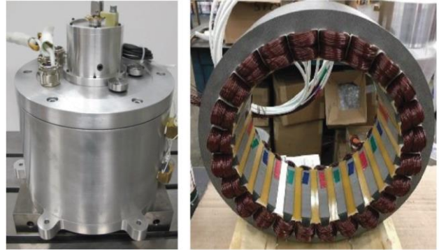
図5 ハイブリッドパワートレインプログラムのカナダエクセレンス研究委員 (CERC) の研究者によって設計されたトラクションハイブリッド電気自動車 (HEV) アプリケーション用の24/16スイッチリラクタン্সモーター
